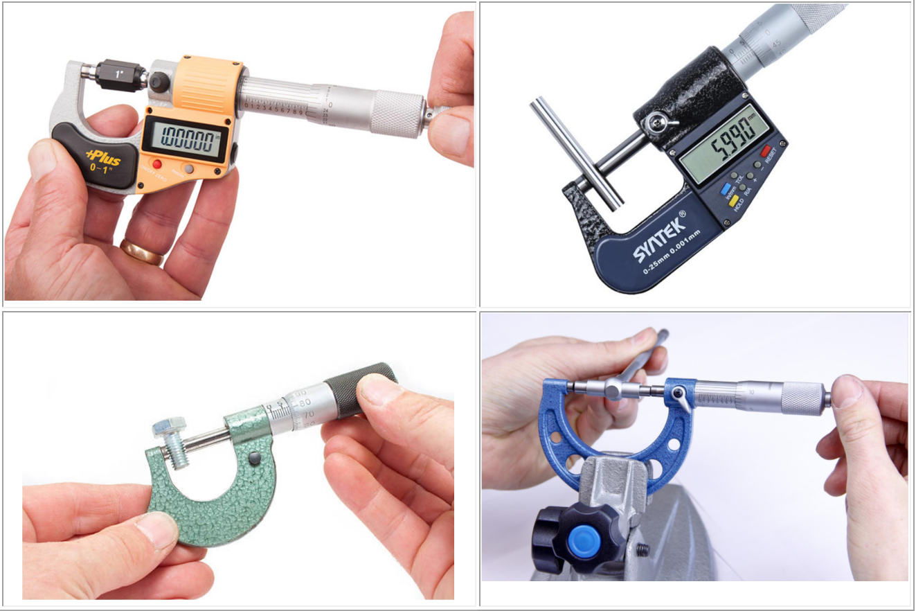
الشكل 2 - الصورة توضح الطريقة الصحيحة لاستعمال مايكرومتر القياس الخارجي
